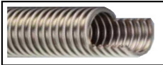
**PRIMJENA:** tlak, podtlak ili vakum svih fluida koji zahtjevaju cijevi od nerđajućeg čelika (praktično gotovo svi fluidi osim solne i fluorne kiseline, te sumporne kiseline razrijeđenja 10-65)
