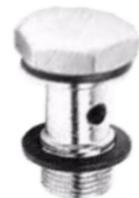
Šuplji vijak M12x1,5 se uparuje sa priključcima s "okom" B 1/4" - NO V. U ponudi su i dvostruki priključci s "okom" za metričke i colne šuplje vijke, kao i dvostruki i trostruki šuplji vijci (za slaganje više priključaka s "okom" jednog iznad drugog).
